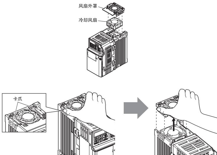
2. 轻轻拉出冷却风扇电缆，卸下中转插头，取出风扇。
