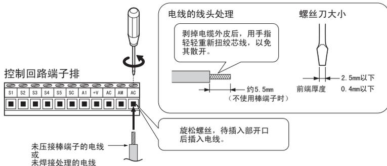
图 3.13 控制回路的接线步骤
