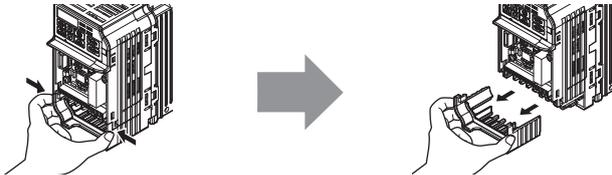
图 3.7 下部外罩的拆卸方法 (柜内安装型: IP20)
