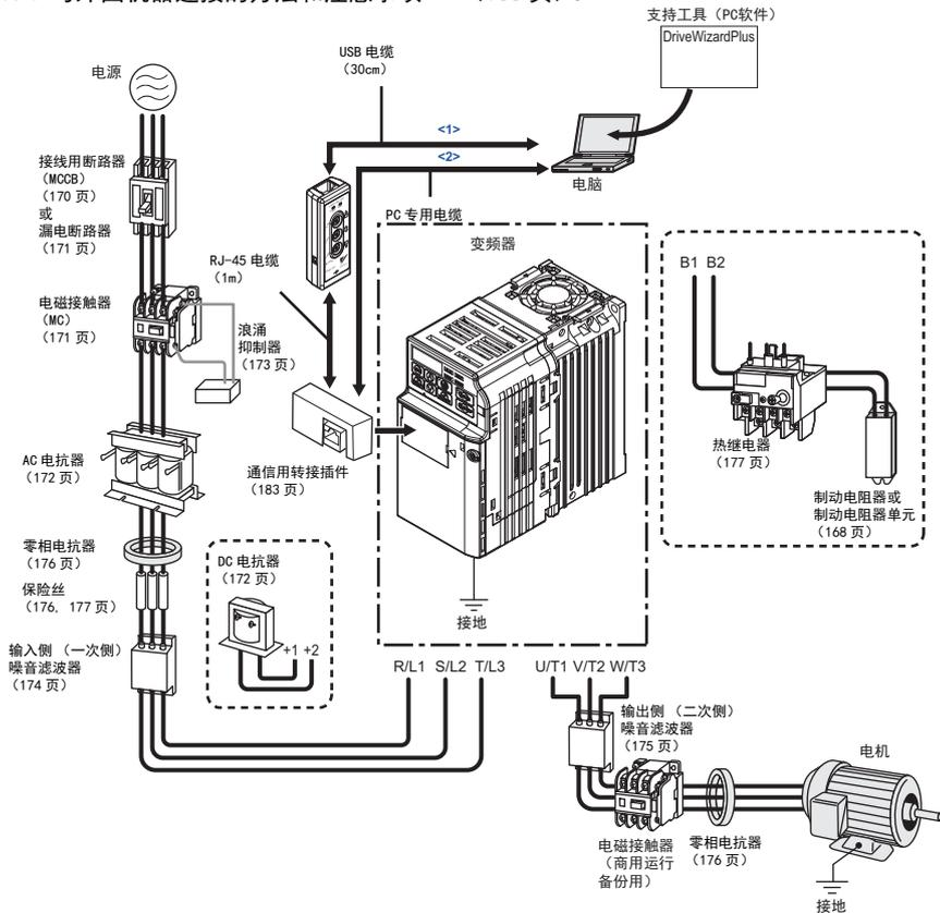
图 7.1 与外围机器的连接
