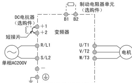
图 3.3 主回路端子的连接
