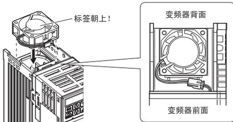
2. 切实安装中转插头，将电缆收纳至电缆槽中。
