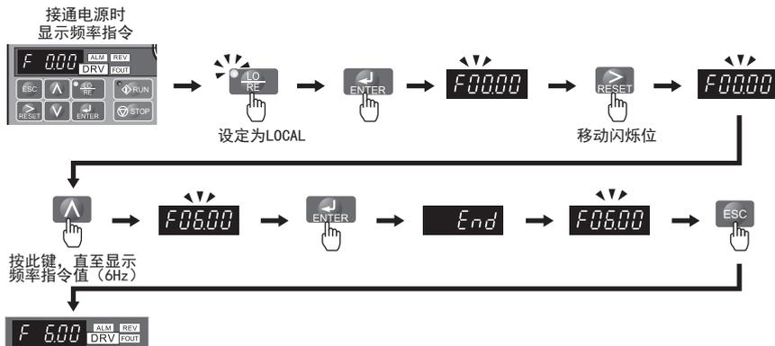
图 4.5 驱动模式下频率指令的设定
