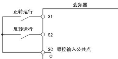
图 4.10 2 线制顺控的接线示例
