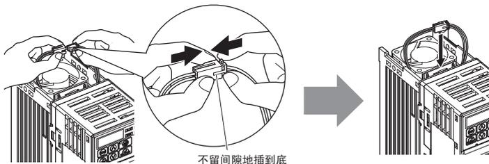
3. 安装风扇外罩时，请将变频器左右外罩卡爪分别对齐。
