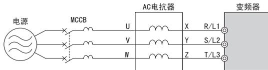
图 7.5 AC 电抗器的连接示例
