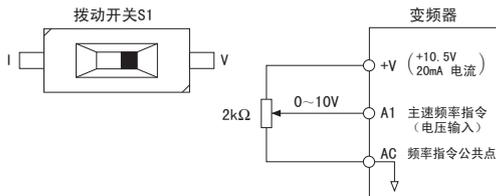
图 4.8 第 1 段速频率指令的电压输入
