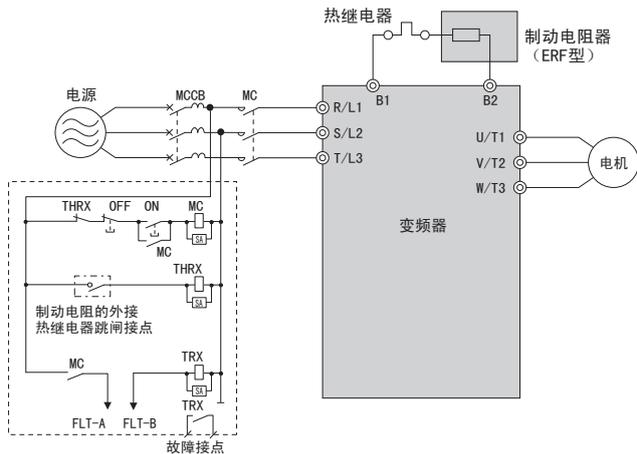
图 7.2 制动电阻器的连接
