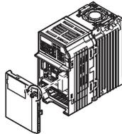
图 3.6 前外罩的拆卸方法 (柜内安装型: IP20)
