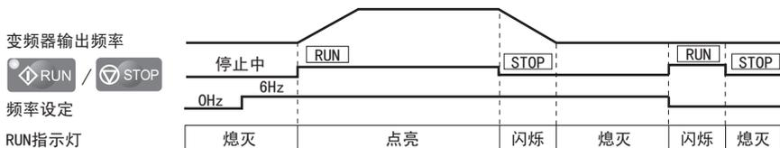
图 4.3 RUN 指示灯和变频器动作的关系
