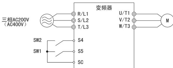
图 4.20 4 段速运行时的控制回路端子
