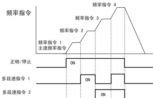
图 4.21 4 段速运行的时序图
