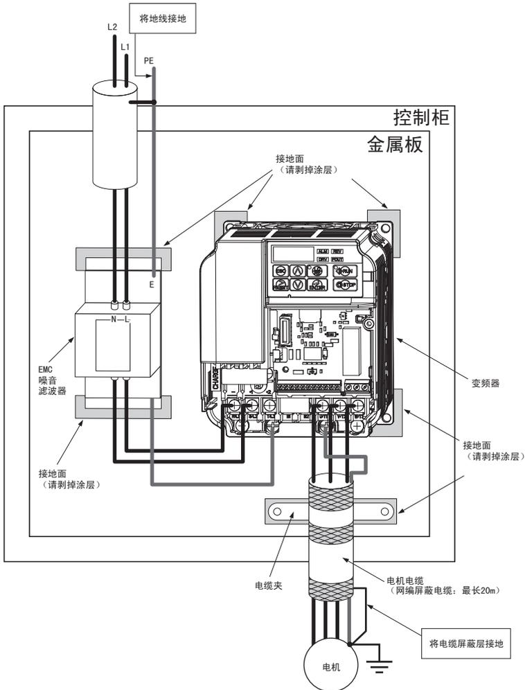
图 C.6 EMC 噪音滤波器和变频器的安装方法 (单相 200V 级)
