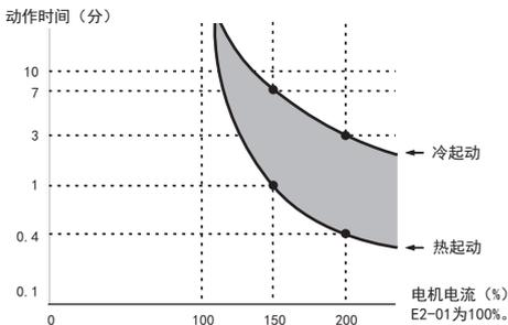
图 C.10 由输出频率和负载决定的电机过载保护时间
