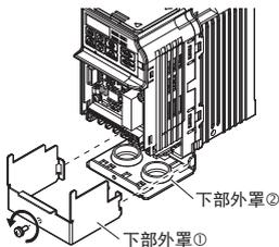
图 7.11 下部外罩的拆卸方法
