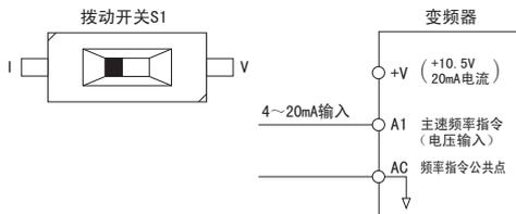
图 4.9 主速频率指令的电流输入
