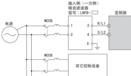
图 7.6 输入侧（一次侧）噪音滤波器的连接示例（单相 200V）
