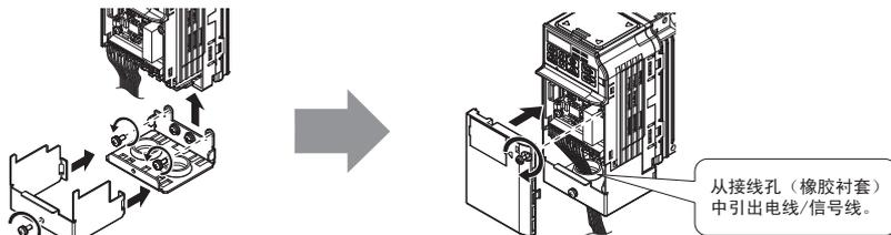
图 7.13 保护罩的安装方法
