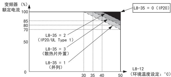
图 A.1 通过变频器安装方法来降低额定值
