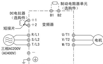
图 3.4 主回路端子的连接
