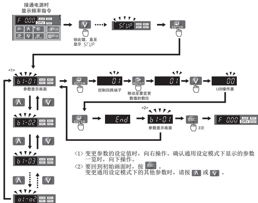
图 4.6 通用设定模式下的键操作示例
