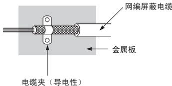
图 C.5 电缆的接地方法
