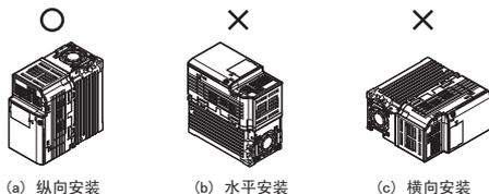
图 2.1 安装方向
