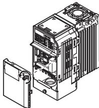
图 7.10 前外罩的拆卸方法
