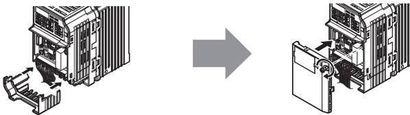
图 3.8 保护罩的安装方法 (柜内安装型: IP20)
