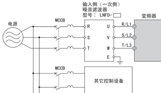
图 7.7 输入侧（一次侧）噪音滤波器的连接示例（三相 200V/400V）
