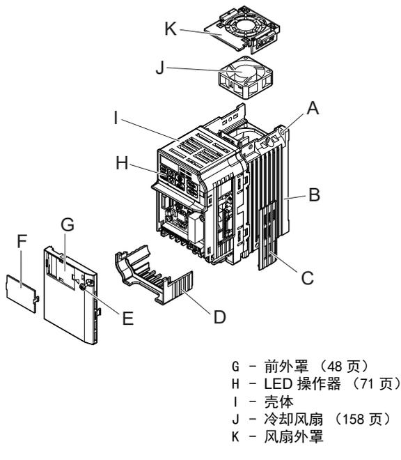
图 1.2 柜内安装型变频器各部分的名称（例：CIMR-J□2A0006B）
