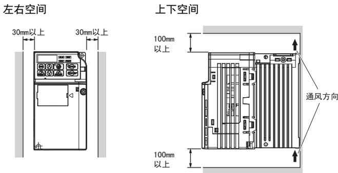
图 2.2 变频器的安装空间（单机）
