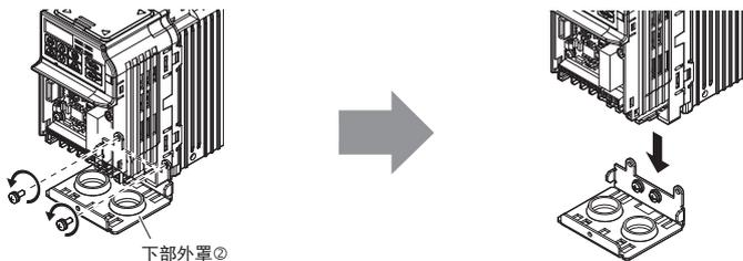
图 7.12 下部外罩的拆卸方法
