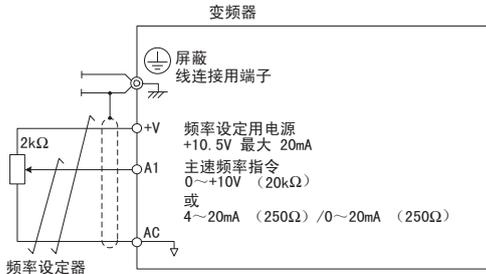
图 3.15 来自控制回路端子的频率指令
