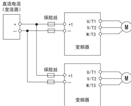
图 C.2 直流电源输入时的示例（并列安装 2 台变频器时）
